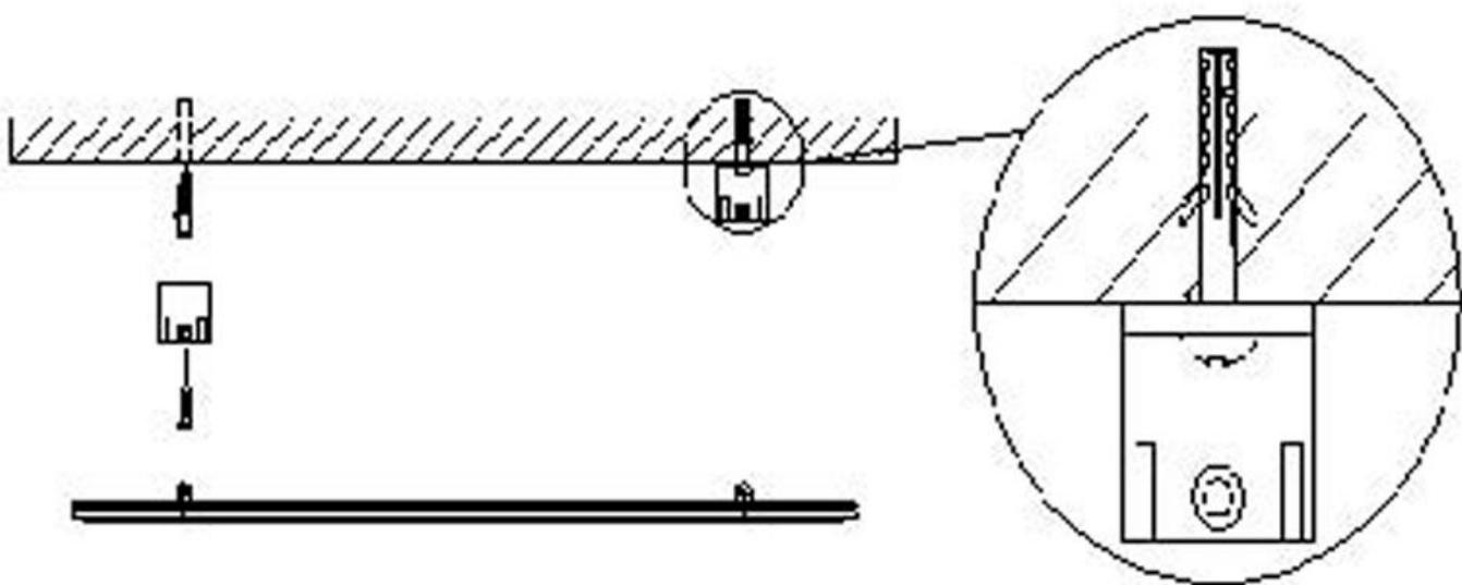
Fissare il pannello avvitando le viti.
